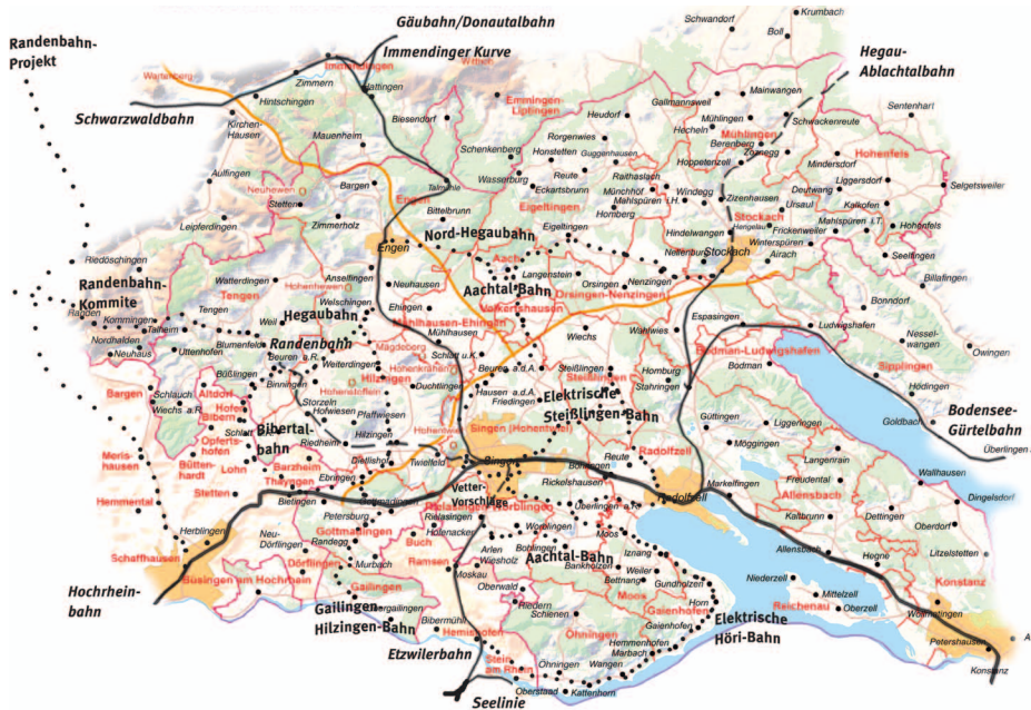
Eisenbahnlinien im Hegau: 1863 bis heute gebaut (durchgezogene Linien), 1875 bis heute gebaut und außer Dienst (langgestrichelte Linien), 1859 bis um 1955 in der Diskussion (kurzgestrichelte Linien)
