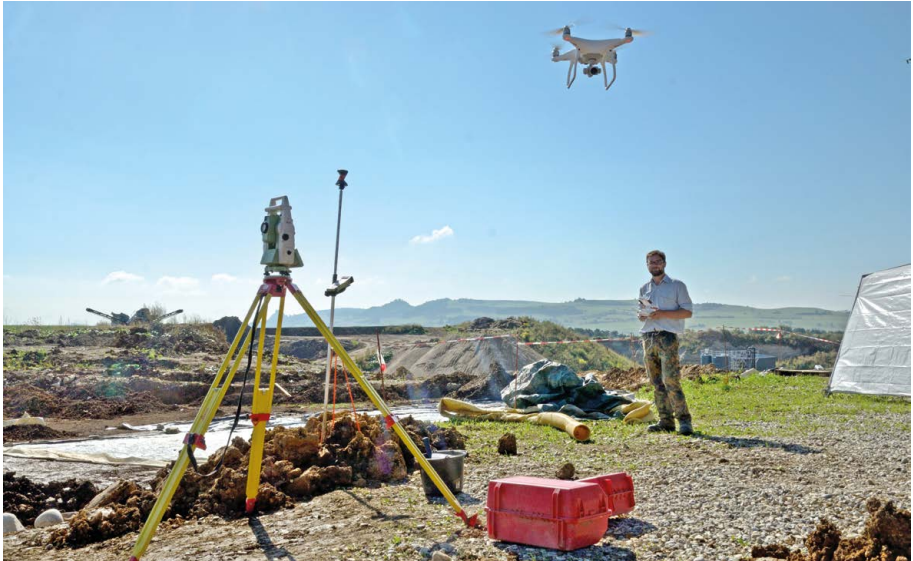
Modernes Vermessungsgerät und Luftbilddrohnen sind wichtige Hilfsmittel für die Dokumentation von archäologischen Befunden auf großen Flächengrabungen – hier im Kieswerk Kohler in Engen-Anselmingen. (Foto: Jürgen Ehrle)
